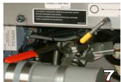
7 VEILLER A CE QUE LA VANNE SOIT TOTALEMENT REFERMEE DANS LE CAS INVERSE LA MACHINE NE CHAUFFE PAS
