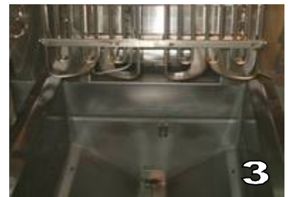
3 RELEVER LES RESISTANCES A L'AIDE DE LA TIGE A DEBOUCHER POUR PERMETTRE LE NETTOYAGE AVEC LA BROSSSE
