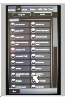
Sélectionner la touche « BOILER FILL VALVE ». Attendre env. 1,5 à 2 minutes pendant que la chaudière se remplit d'eau froide.
