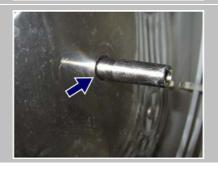
Veiller alors à ce que l'arbre moteur soit positionné au milieu dans l'enceinte de cuisson.
