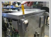
Bloquer les freins à l'aide d'un tournevis à douille de 8. **Remarque**: Desserrer à nouveau les freins pour déplacer l'appareil ou le kit de superposition.
