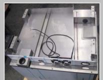
Poser l'adaptateur sur l'appareil inférieur.
