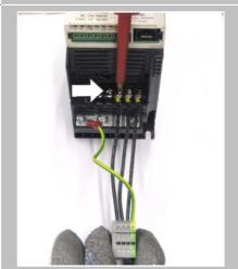
Desserrer tous les câbles en sortie du variateur de vitesse à l'aide d'un tournevis cruciforme.
