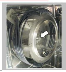
Porter impérativement des gants de protection! Enlever la vis à tête hexagonale sur l'hélice du ventilateur à l'aide d'un cliquet à douille de 17. Mettre à la place de celle-ci la vis à épaulement issue du kit d'extraction et serrer celle-ci fermement à la main.
