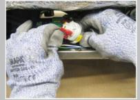
Retirer les deux connecteurs plats sur le pressostat.
