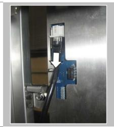
Déverrouiller le câble du réseau local sur la carte d'interface système et retirer le câble.
