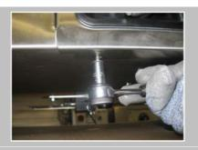
Ôter les 2 vis du capot à l'aide d'une clé plate ou d'un cliquet (de 8).
