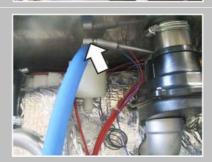
Desserrer le collier de tube de remplissage de chaudière à l'aide d'un tournevis à douille de 7.
