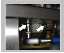
Enlever les vis du fond de l'appareil à l'aide d'un cliquet à douille de 7
