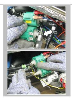
Des deux côtés, détacher les tuyaux de la pompe de dosage. Tirer par le haut la pompe et la sortir.
