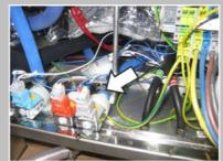
Desserrer le collier de tube à l'aide d'un tournevis à douille de 7 et tourner le tuyau sur l'électrovanne pour le rendre lâche.
