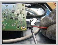
Débloquer soigneusement l'ergot de verrouillage du connecteur et enlever le câble du haut-parleur hors de la platine.
