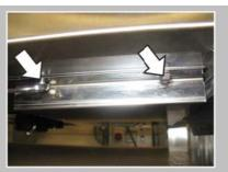
Ôter les 2 vis à l'aide d'une clé plate de 10.
