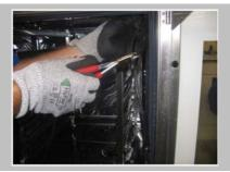
Couper l'ancienne sonde. Le câble de la sonde TàC restant dans l'appareil sera utilisé plus tard comme fil de traction.
