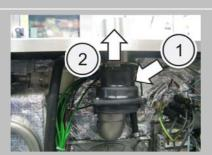
Desserrer la vis du collier de tube (1) sur le manchon d'aération à l'aide d'un tournevis à douille de 7 et retirer le manchon d'aération (2).
