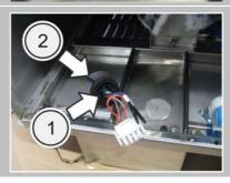
Passer soigneusement le câble à travers le passe-câble à membrane (1) et l'ouverture (2).
