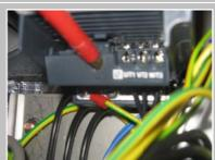
A l'aide d'un tournevis cruciforme, appuyer dans l'orifice et soulever le capot inférieur du variateur de vitesse (sortie variateur).
