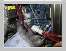
Déverrouiller et retirer le connecteur (X2Q0).
