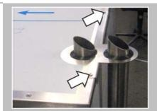
Monter la plaque de fixation à l'aide des 2 vis cruciforme.
