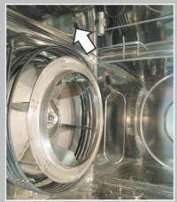
Désélectionner la touche « BOILER FILL VALVE » dès que l'eau déborde par l'ouverture de la chaudière dans l'enceinte de cuisson.
