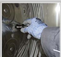
Enfiler la rondelle centrifuge sur l'arbre moteur dans l'enceinte de cuisson.
