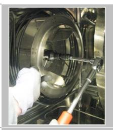
Appliquer l'extracteur d'hélice dans la rainure de l'hélice de ventilateur.
