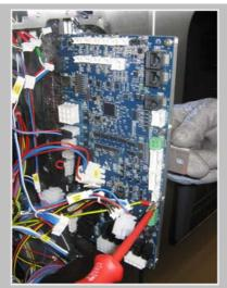
Desserrer la vis du câble de masse à l'aide d'un tournevis cruciforme.
