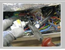
Appuyer sur le collier de tube à l'aide d'une pince universelle et retirer le pressostat.
