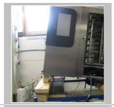
Incliner l'appareil en plaçant des cales de 20 cm de hauteur env. sous les pieds gauches de l'appareil.
