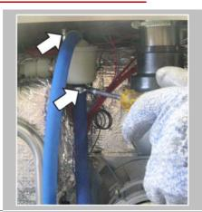
Desserrer les deux colliers de tube à l'aide d'un tournevis à douille de 7 et enlever les tuyaux sur la sécurité anti-retour d'eau par siphonage.
