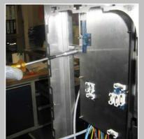
Ôter la vis sur la plaque à l'arrière de la carte IS à l'aide d'un tournevis à douille (de 8).
