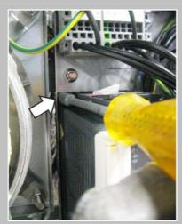
Enlever la vis du haut sur le variateur de vitesse à l'aide d'un tournevis à douille de 7.
