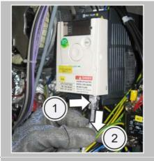
Déverrouiller le câble de données (1) et tirer le connecteur (2) vers le bas.
