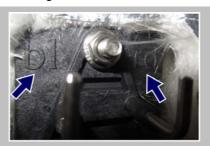
Lors du raccordement de la sonde de niveau d'eau, veiller à respecter l'ordre correct des deux conducteurs.
