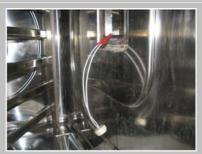
Sortir la douille de lampe et détacher les connexions serties.
