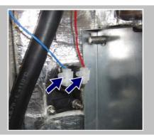
Desserrer les vis des barrettes de connexion sur le conducteur rouge et sur le bleu, à l'aide d'un tournevis.
