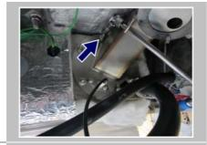
Desserrer les 6 vis à l'aide d'un cliquet à douille de 10, avec prolongateur coudé.
