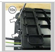
Débloquer les 10 attaches soigneusement à l'aide d'un tournevis et retirer le capot arrière sur les crans.
