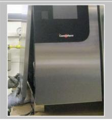
Écarter sur le côté la partie inférieure et retirer la face de gauche vers le bas.
