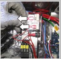
Tirer sur le connecteur pour le débrancher.
