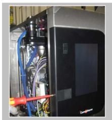
Ôter la vis sur le côté gauche du panneau IU à l'aide d'un tournevis cruciforme.
