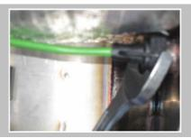
Dévisser la sonde bipasse en la tournant à l'aide d'une clé plate de 17.
