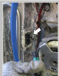
Enlever les deux barrettes de connexion de la sonde de niveau à l'aide d'un tournevis cruciforme.
