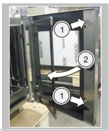
Ouvrir les pattes de maintien de la vitre intérieure (1) et ouvrir celle-ci (2) en la pivotant.
