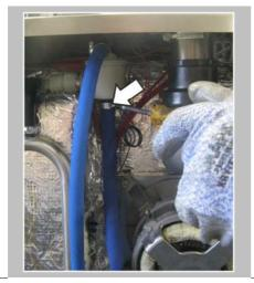
Desserrer le collier de tube inférieur de la sécurité anti-retour d'eau par siphonage à l'aide d'un tournevis à douille de 7.
