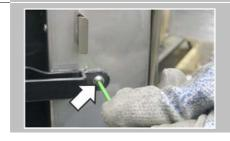
Desserrer les deux vis à gauche et à droite de l'égouttoir de porte à l'aide d'une clé six pans taille 2,5 et déposer l'égouttoir de porte.
