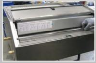
Enfiler le filtre à fines particules dans l'ouverture.
