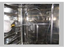
Démonter les 4 vis à tête hexagonale de la lumière de l'enceinte de cuisson à l'aide d'une clé plate de 8.
