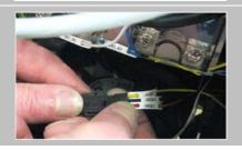
Déverrouiller et détacher la liaison connectée X6Q0.
