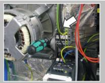
Débrancher les six câbles de l'élément chauffant de l'enceinte de cuisson.
