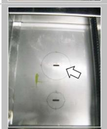
Dans le compartiment électrique, rompre l'ouverture perforée.
