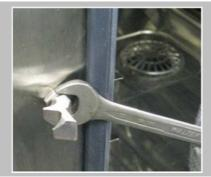
A l'aide d'une clé plate de 13, desserrer le contre-écrou sur la gâche.
