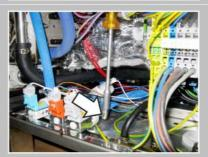
Desserrer le collier de tube sur l'électrovanne de la douchette à enrouleur à l'aide d'un tournevis à douille de 7 et séparer le tuyau de l'électrovanne.
