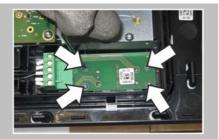
Retirer les quatre vis situées au dos de la platine de l'interrupteur général à l'aide d'un Torx T9.
