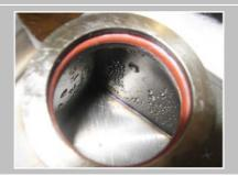
Insérer le joint torique soigneusement dans le tube. Lors du montage, veiller à ce que le joint torique soit bien en place.
