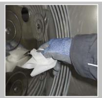
Nettoyer l'arbre moteur à l'aide d'un produit dégraissant. L'arbre moteur et le cône doivent être absolument exempt de graisse.
