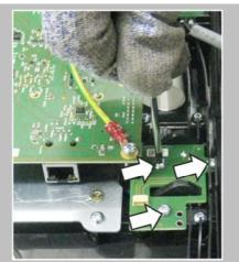
Retirer les trois vis situées au dos de la platine de l'interrupteur général à l'aide d'un Torx T10.
