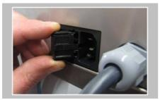
Enclencher le porte-fusible dans l'ouverture.
