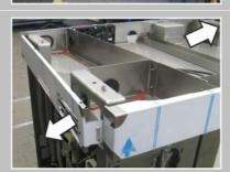
Retirer les panneaux enfichés à gauche et à droite de l'adaptateur.
