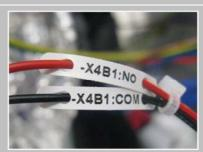
Veiller au raccordement correct (NO/COM) du connecteur sur le pressostat.
