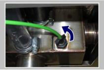
Sortir la sonde de mesure des eaux usées en la tournant à l'aide d'une clé plate de 17.
