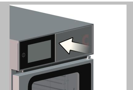
Appuyer sur le côté gauche du volet de la façade de commande pour déverrouiller la fermeture de la trappe.
