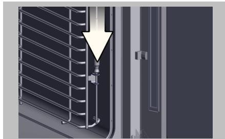
Poussez le capteur de température à cœur dans le support sur la glissière droite.
