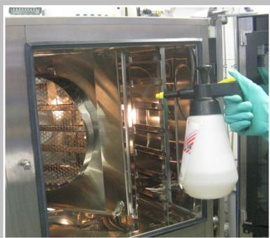
Pour la neutralisation, aspergez l'enceinte de cuisson, devant et derrière la tôle d'aspiration avec ConvoClean new ou ConvoClean forte.
