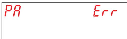
Si l'ancien mot de passe inséré est correct, il est demandé d'insérer le nouveau mot de passe. Avec les touches **B** (diminue) et **C** (augmente), composer le nouveau mot de passe. Confirmer la sélection de chaque chiffre en appuyant sur la touche Start **A**.
