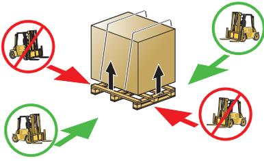
Le déplacement des machines doit se faire strictement, comme indiqué dans la **Fig. 1** relativement aux points d'accrochage indiqués pour le soulèvement avec chariot élévateur. Assurer la machine de façon que durant le transport, il n'y a pas de mouvements accidentels de celle-ci.
