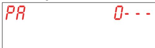
Avec les touches **B** (diminue) et **C** (augmente), sélectionner le mot de passe (default 1111) en définissant les chiffre. Confirmer la sélection de chaque chiffre en appuyant sur la touche Start **A**. Si un mot de passe erroné est inséré, l'avertissement **PA Err** relatif apparaît.
