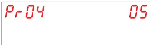
Les paramètres sélectionnables vont de 1% à 100% pour un débit de dosage min. de 0,1 l/h et un max de 1 l/h.
