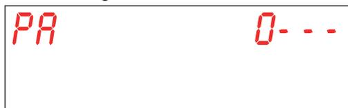
Avec les touches **B** (diminue) et **C** (augmente), sélectionner le mot de passe de le technicien (default **1111**) en définissant les chiffres. Confirmer la sélection de chaque chiffre en appuyant sur la touche Start **A**. Si un mot de passe erroné est inséré, l'avertissement **PA Err** relatif apparaît.
