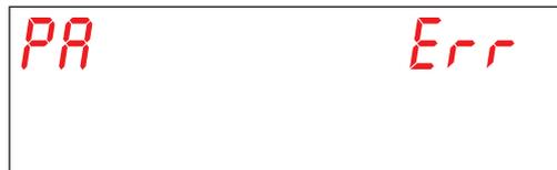
Ce paramètre permet de rétablir tous les paramètres d'usine de la machine.
