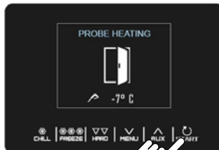
La sortie Réchauffement sonde à aiguille est activée au maximum pendant le temps établi avec le paramètre u8 ou jusqu'à ce que la température détectée par la sonde à aiguille atteigne celle établie avec le paramètre u7. À la fin du réchauffement, la sonnerie retentit pendant une seconde et la carte revient sur la page d'accueil.
