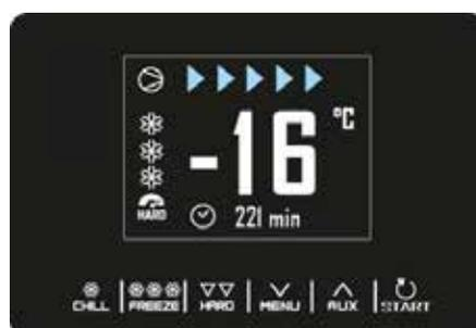
Une fois le cycle de refroidissement rapide positif terminé, en raison de l'obtention de la température de la sonde à aiguille ou en raison de la fin du temps réglé, la sonnerie retentit et la phase de conservation commence ; si le cycle à température ne se termine pas dans le temps établi, l'anomalie sera signalée par la présence du message d'alarme.
