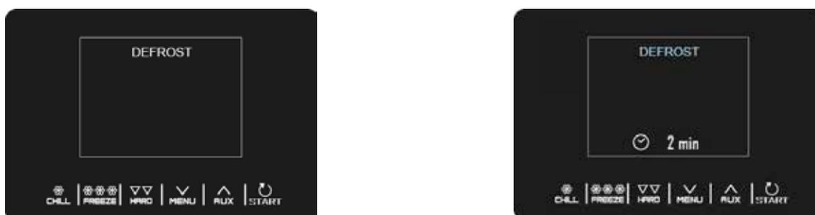
Le dégivrage est également effectué automatiquement pendant la conservation ou le prérefroidissement à des intervalles de temps définis par le paramètre d0, à condition que la valeur ne soit pas réglée sur 0.
