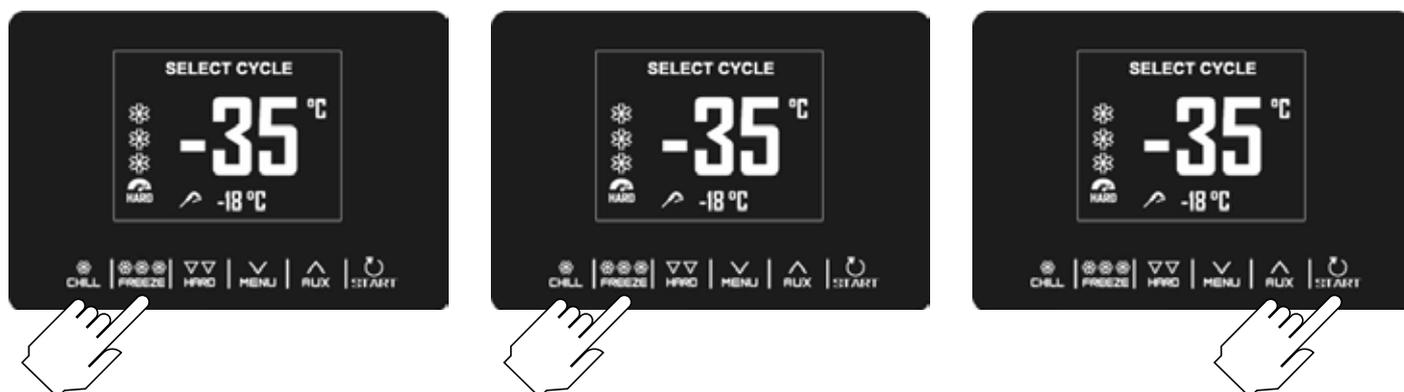
Le cycle sélectionné proposera soit les paramètres préchargés pour ce cycle, soit les paramètres du dernier cycle effectué (en fonction du paramètre r36). En appuyant sur « Aux » « Menu », il est possible de modifier rapidement, dans les plages autorisées, la valeur d'une seule donnée (établie par le paramètre r35).
