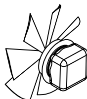
MOTOVENTILATEUR: HELICE COD.4012019 MOTEUR COD. A.106.507
