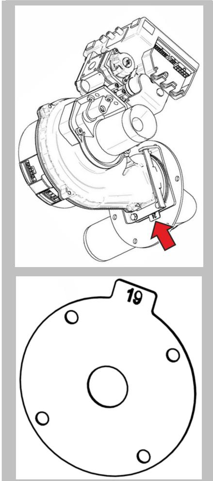
Sur la bride respective du brûleur se trouve derrière le ventilateur un chiffre (= Ø de l'obturateur d'air).
