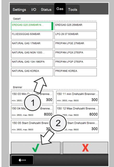
Dans l'onglet « Gaz » sélectionner le type de gaz désiré (1) et confirmer (2).
