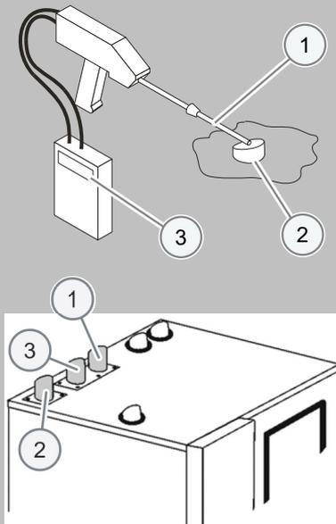
Insérer la sonde de mesure de l'appareil de mesure des gaz de fumées (1) dans le raccord d'échappement des gaz de fumées (2) du brûleur à analyser.
