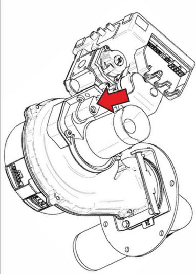
Si la valeur de gaz de fumées diffère nettement de la consigne, régler la valeur désirée pour les gaz de fumées à l'aide de la vis (Torx 25 ou six pans de 4) sur la vanne Venturi.
