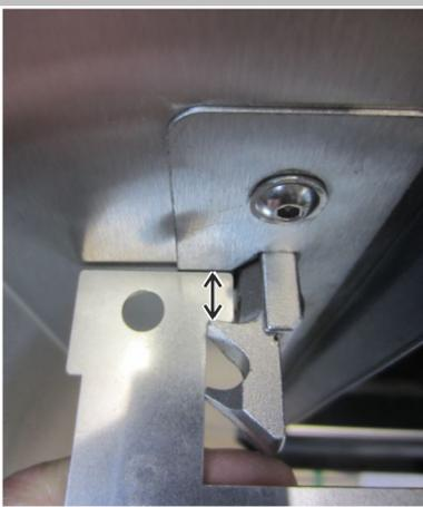
Régler le crochet jusqu'à ce que le crochet bas repose sur la butée avec l'outil de réglage pour appareils de table.
