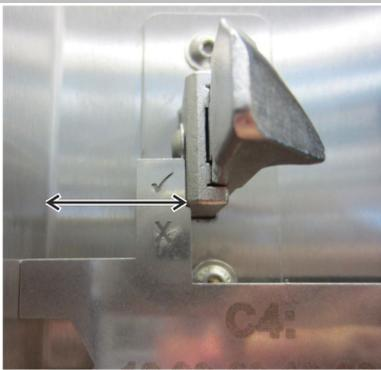
Vérifier si le crochet se situe dans la plage OK de l'outil de réglage pour appareils sur pieds.
