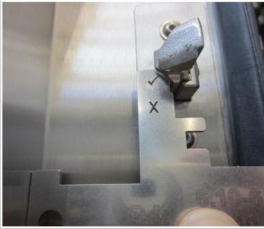
Vérifier si le crochet se situe dans la plage OK de l'outil de réglage pour appareils de table.
