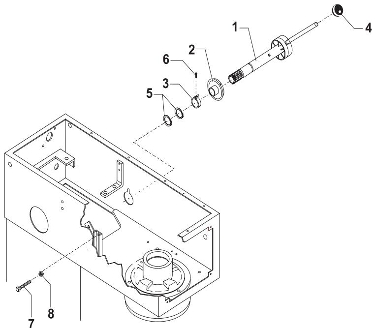
AR81-47Z .....changer l'axe de la roue d'engrenage ..... Change-over gear wheel shaft AR81compl
