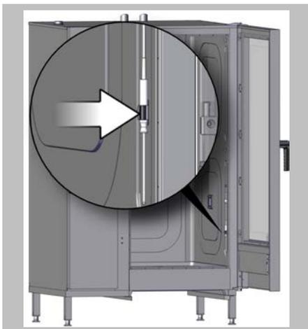
Clipser le capteur de température à cœur dans le support.
