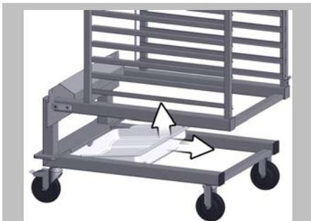
Tirer le bac de collecte de condensation un peu vers l'arrière. Soulever légèrement le bac à condensats sur la butée, afin de pouvoir le tirer vers l'arrière au-delà de la butée.
