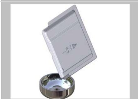
Verser le condensat du bac de collecte de condensation dans un égout.
