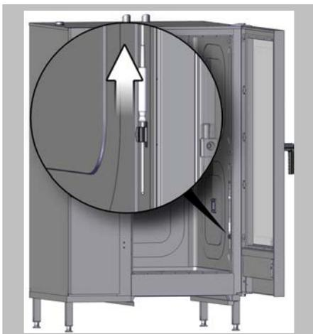
Tirer le capteur de température à cœur hors du support.
