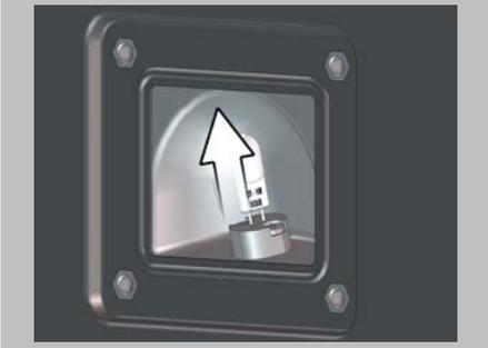
3. Par l'ouverture dans la paroi de l'enceinte de cuisson, accéder dans le boîtier du réflecteur et sortir droit la lampe halogène.
