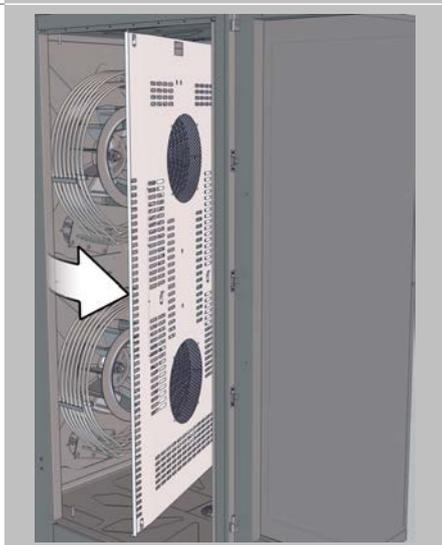
Pivoter la tôle d'aspiration dans l'enceinte de cuisson.
