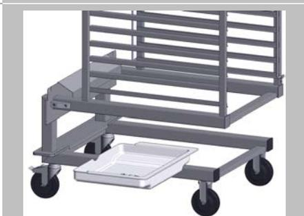
Lever le bac de collecte des condensats horizontalement hors du chariot de chargement.
