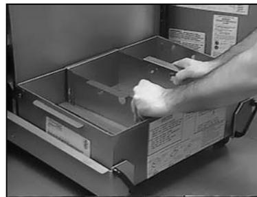
5. Poussez le bac à fond dans la friteuse. (Quand le filtre FM II est correctement positionné, le voyant HEATER ON vert s'allume.)
