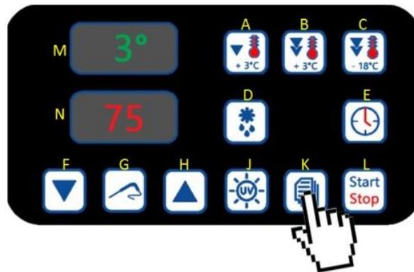
L'afficheur **M** visualisera le numéro du premier programme non utilisé. Il est possible de sélectionner une autre étiquette en utilisant les touches **F** (diminution) et **H** (augmentation). Une fois le numéro sélectionné, appuyer à nouveau sur la touche **K** pendant 5 secondes. La recette est mémorisée.
