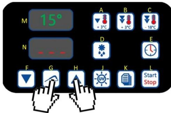
Sinon, presser simultanément les touches **F** et **H** pendant 5 secondes puis sélectionner la sonde désirée à l'aide des touches **F** et **H** dans la liste suivante :
