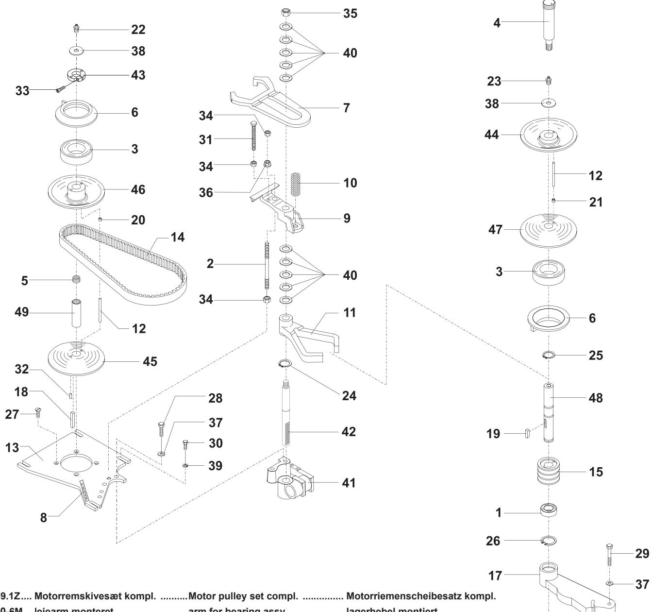
R60-59.1Z.... Motorremskivesæt kompl. .... Motor pulley set compl. .... Motorriemenscheibesatz kompl.
